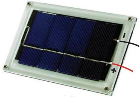
(3 أردنا التأكد من كون هذا اللوح يقدم لنا تيار كهربائي جهده 9V فقمنا بعرضه لأشعة الشمس
